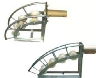
●用途：三轮，曲率半径450mm，四轮，弯曲半径1000mm，滑轮可按牵引需要以任何角度旋转于孔口，并可锁紧，尼龙轮，钢件表面镀锌
